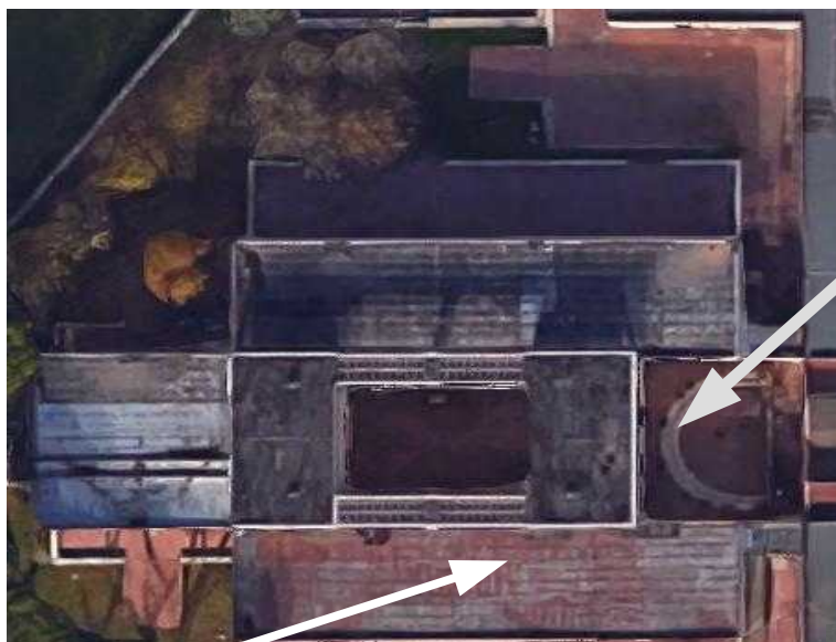
Foto 7: Particolare del deterioramento della copertura. Da questa fessura si origina l'infiltrazione visibile nel corridoio Piano I [foto 4].
